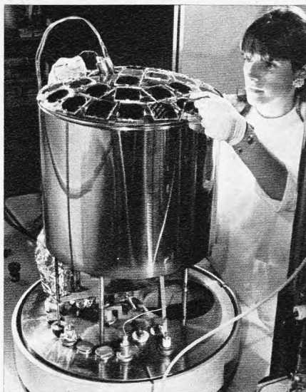
In diesem Vakuumgefäß wird die endgültige, für die Fertigung erforderliche Maske der IS auf einen Glasträger übertragen. Die Glasmasken sind im Gebrauch widerstandsfähiger als Masken auf Film
